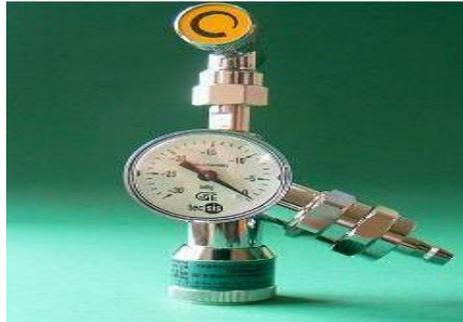
Los manómetros tienen diferentes escalas de acuerdo al rango de presión que se requiere medir. Normalmente las escalas vienen graduadas en psi. Cabe recordar que los manómetros miden presiones manométricas, es decir que indican cero cuando la Presión absoluta es 1 atmósfera (14.7 psi). Esto se expresa como psig (gauge) para distinguir de los psia (absolutos). Cuando no se agrega esta última letra aclaratoria se entiende que se refiere a presiones manométricas.
